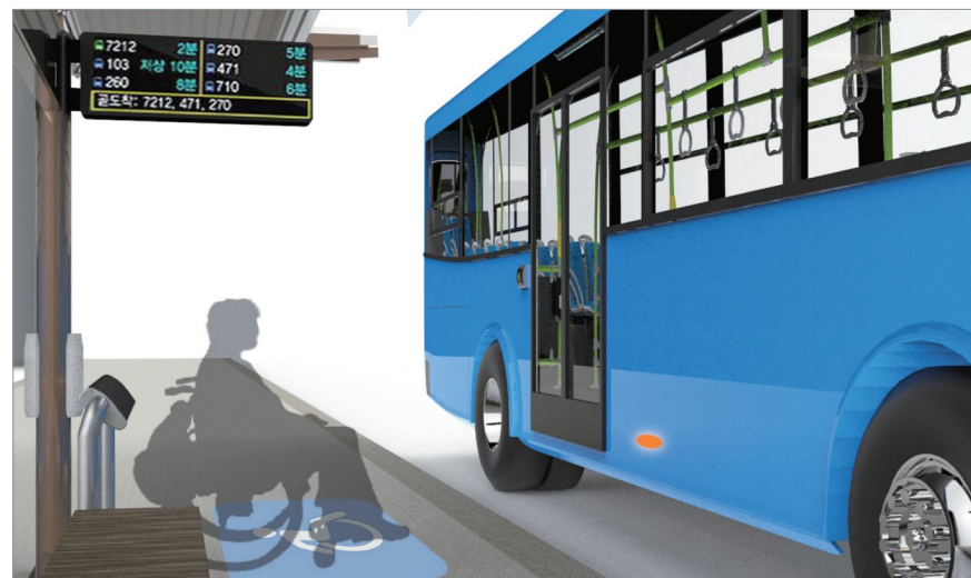
[그림 3-3] 자동경사판 작동 시 점멸등 및 음성 안내방송 예시
