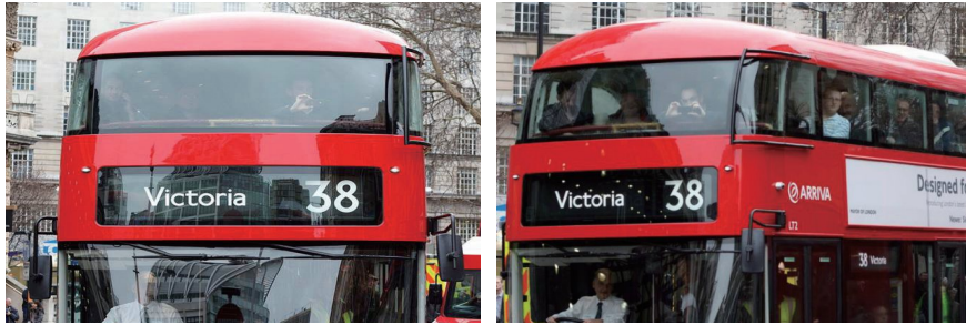
[그림 4-24] 버스외부 전면 LED 운행정보
