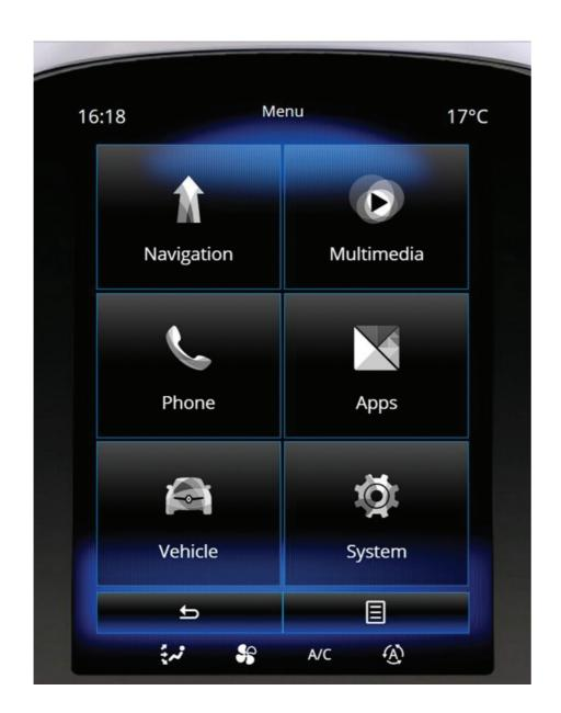
CONNECTED VEHICLE 등 자동차에 infotainment systems이 더욱 중요해지고 대형화되고 있는 상황에서 8.7" 대형 touch display를 이용한 AVN을 작업하였습니다. 큰 디스플레이에 맞는 정보 시인성과 조작성에 중점을 두어서 추후 각종 차종에 맞게 컬러와 화면 사이즈가 가변이 되는 부분에 중점을 두었습니다.
