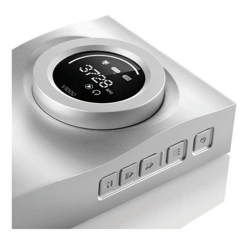
플로우는 하이파이 헤드폰 앰프로 무압축 음악 파일을 고해상도로 재생해 주는 기능을 합니다. 하이파이 오디오 기기의 특성을 바로 느낄 수 있도록 하기 위해, CMF와 가공방법에 공을 들였습니다. 장축면으로 압출하고, 절삭량을 최소화하여 CNC절삭 가공 CASE임에도 대량생산 및 COST에 대응할 수 있도록 디자인 단계에서부터 철저하게 고민하였습니다. 알루미늄의 차가운 감성의 재료에 따뜻한 음악의 선율을 모티브로 디자인에 담고자 하였으며, 볼륨 노브와 연동 되어 움직이는 볼륨 게이지 비등 사용중에 느낄 수 있는 디테일한 감성에 공을 들였습니다.
