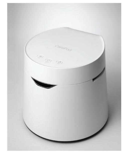
기존의 세척이 힘든 가습기의 구조를 탈피하여, 가습이 되는 모든 파트를 분해하여 세척이 가능하게 디자인되었으며, 내부 수조를 스테인리스로 제작하여 분리 후 세척 및 직접 가열하여 100% 완전살균이 가능하도록 하였습니다. 기존의 초음파 가습기들은 가습할 수 있는 물의 용량의 한계가 있지만, 케어팟은 물의 높이에 따라 유동적으로 움직이는 진동자 구조를 통해서 큰 용량의 물통을 한번에 장착할 수 있는 구조를 가지고 있습니다. 기술적인 내부 구조와는 상반되게 외부 디자인형태는 최대한 심플, 미니멀 하게 디자인되었으며, 제품의 디테일들은 히든 LED바와 터치버튼 등 최근 디자인 트렌드를 반영하여 디자인 되었습니다.
