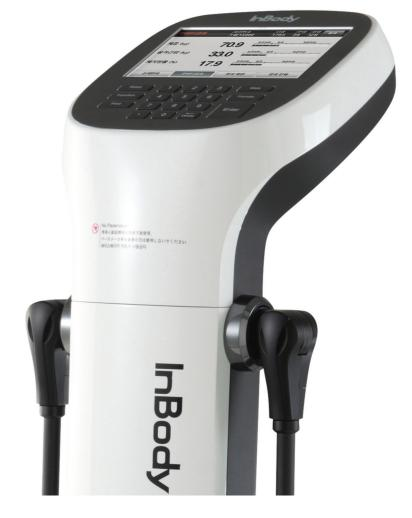
인바디는 세계최초로 4극 8점 터치식 전극법을 적용하여, 발판에 올라서서 양 손에 손잡이를 쥐는 것 만으로 30초 이내에 우리 몸을 구성하는 성분을 분석하여 비만 진단뿐만 아니라 인체 성분의 과부족을 진단하는 의료기기입니다. 두 사람이 두 손을 마주 잡고 서 있는 듯한 측정 자세에서 힌트를 얻어 인체의 형상을 모티브로 하여 '늘 사람과 가까이 하는 제품' 이라는 컨셉으로 디자인하였습니다. 인바디는 고유 기술을 바탕으로 세계 각지에 특허를 출원하여 전세계 유명 병원과 대학에서 검진 및 연구장비로 널리 사용되고 있습니다.
