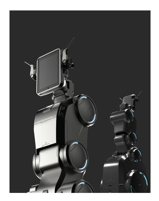
교육용 콘텐츠 및 커뮤니케이션 등을 위한 서비스 로봇으로 Mechanical 컨셉을 반영함으로써 기존 캐릭터 위주의 교육용 로봇과 차별화된 제품입니다. 안면부에 장착된 PAD를 통해 콘텐츠 확인 및 모니터링이 가능하며 몸체 각 부분의 관절을 통해 상하 위치 조절과 이동이 가능하여 다양한 연령대의 소비자가 이용할 수 있습니다.
