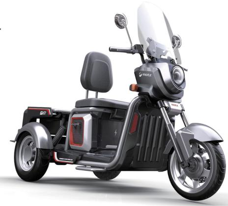
전기를 통한 경제적 운행과 사용자의 요구에 맞게 원하는 형태로 커스터마이징하여 다양한 필드에서 목적에 맞게 사용할 수 있게 하는 삼륜 바이크입니다. 인간 공학적 설계를 기준으로 힙포인트를 고려한 좌석의 사이즈, 착탈식 보조 발판, 적재함으로 사용자의 사용성과 편의성, 안정성을 고려하였으며, 착탈식 보조배터리를 통한 이동거리 및 전력을 효율적으로 증가시켜 기존의 제품보다 더 나은 주행환경을 운전자에게 제공합니다.
