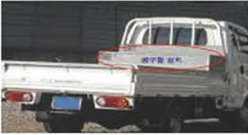
[적재함에 공구함 설치]
