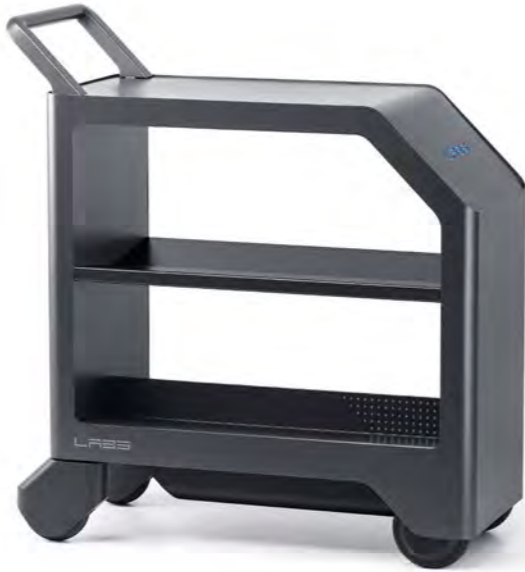
에어카트. 전면의 휠 안에 모터를 내장하고 핸들에 장착된 2개의 로드셀 센서로 사용자가 의도하는 방향을 인식해 진행 방향으로 힘을 더해준다. 현재 부산의 YES24 매장에서 운영하고 있다.
