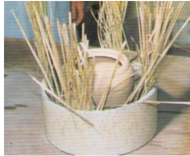
그림47 비젠아끼 갑발에 넣어 소성하는 모습.
