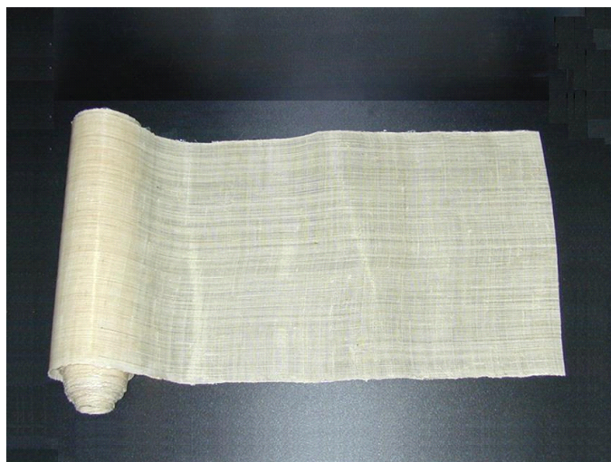
<그림 6.3.20> 조명기구의 전등갓부분에 사용된 라미네이트한 마대
