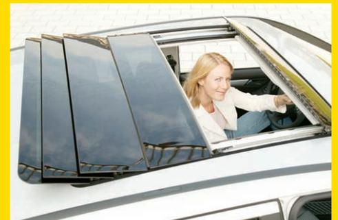
어, 대체 된다면 20kg 정도의 무게를 줄일 수 있게 된다. 특히 좌석의 옆 유리는 자동차 사고 시 깨지면서 탑승자를 위협하기도 하여 유리보다 충격에 강한 폴리카보네이트로 대체되었을 때 안전성도 개선하는 역할을 하게 된다. 유리는 폴리카보네이트보다 자외선에 강하고 긁힘에 강하다는 장점은 있다. 이런점을 보완하기 위해 폴리카보네이트에 자외선과 표면을 보호하기 위한 코팅을 한다.
