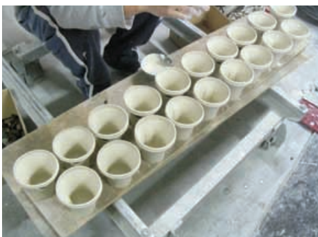
그림 3. 주입 성형법인 슬립캐스팅으로 성형하는 과정
