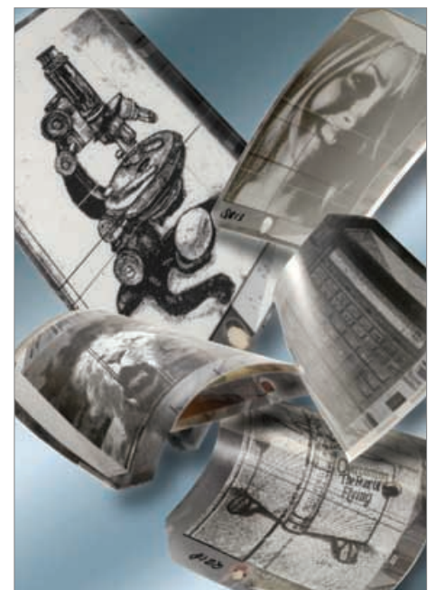
그림 3. 필립스의 접는 스크린 (해상도 850dpi, 곡률반지름 2cm)
