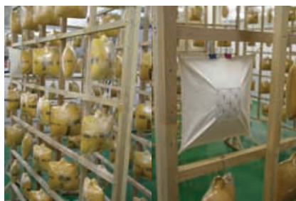
그림 1. MEMORY 성형 과정 스티치된 한결지를 성형틀에 씌우고 물을 뿌려놓으면 모서리에 연결된 고무줄에 의해 팽창하여 그 형태가 잡히고 열풍에 의해 건조되어 완성된다.
