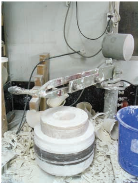
그림 4. 자동 물레 성형법의 지거링(Jiggering) 기계
