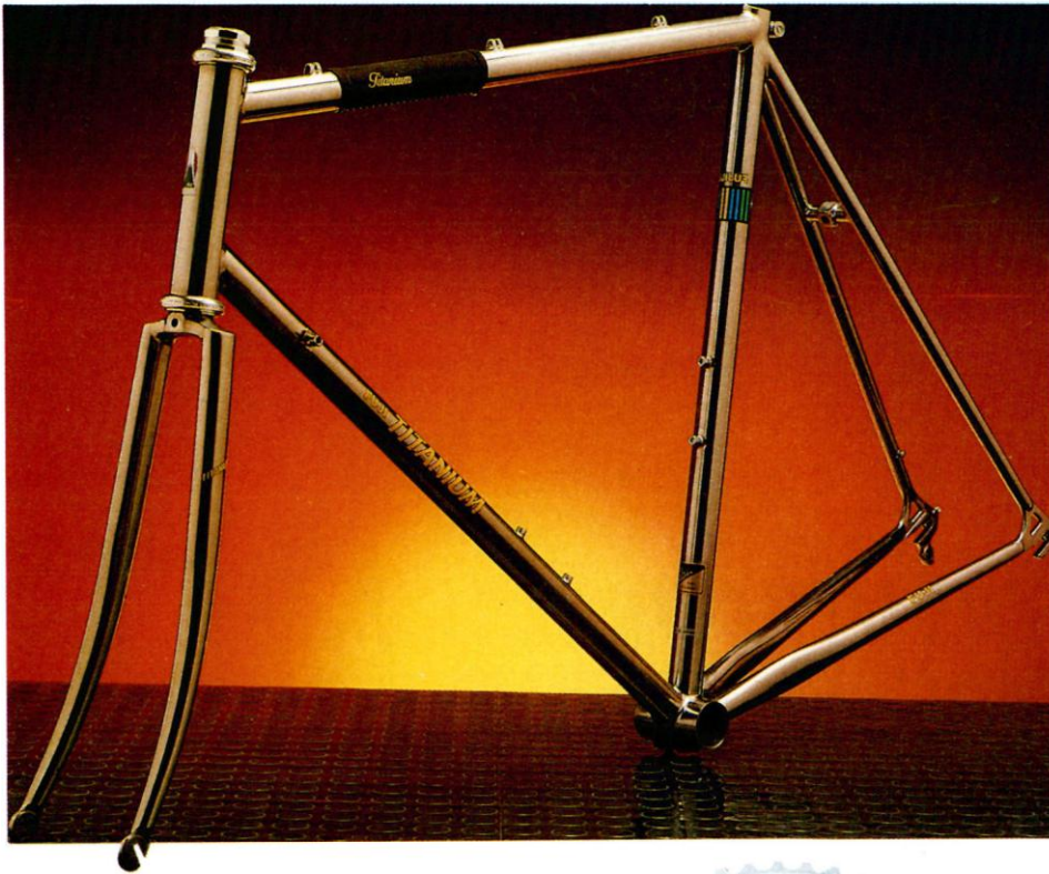
사진14> TITANIUM으로 제작된 FRAME의 한 예 : 티타늄을 소재로 한 FRAME으로써 이 소재는 용접 후에도 강도가 떨어지지 않아 Lug가 없는 FRAME 제작이 가능하다.
