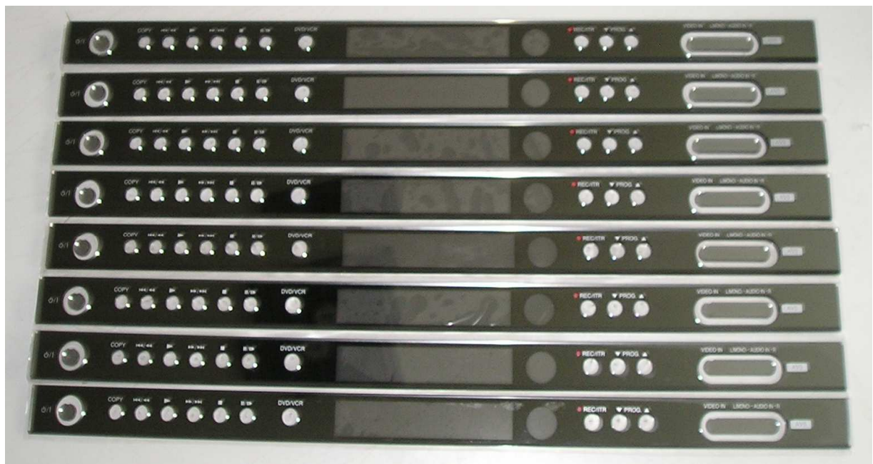
< 그림 32 >. SUS 계열의 하프 미러 CNC 작업후 sample
