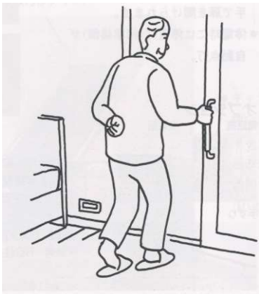
<그림7-42> 문을 열고 닫을 때의 안전성이 고려된 도어 손잡이
