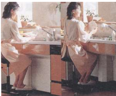
<그림 7-4> 휠체어나 의자에 앉아서 작업을 할 수 있도록 싱크대의 아래를 오픈 하였음
