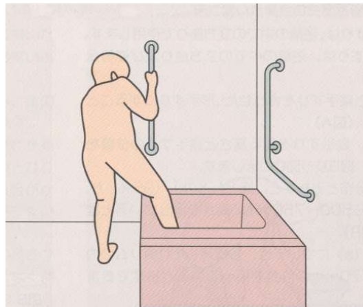
<그림 7-23> 욕조출입을 돕기 위한 세로 서포트바
