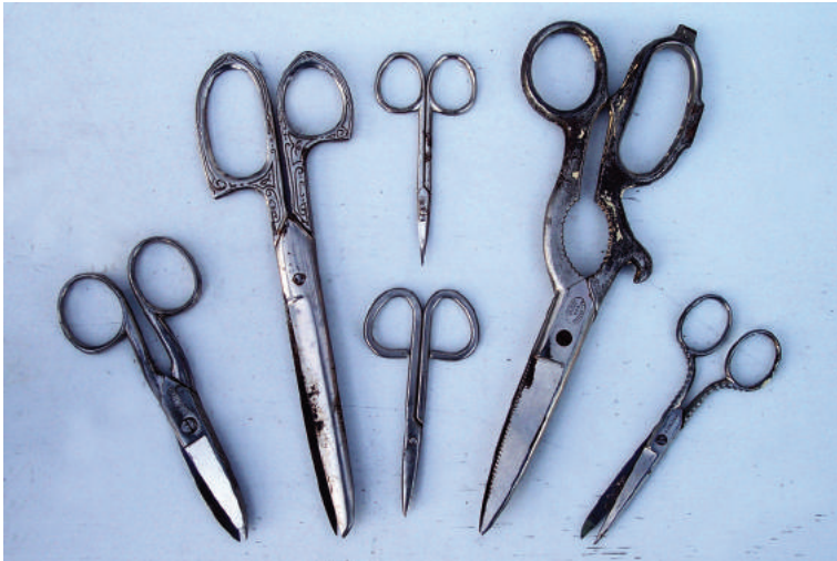
'제약'의 원리가 잘 구현된 가위 디자인. 가위의 구멍은 안으로 손을 넣으라는 시각적 단서를 제공한다.
