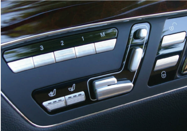
자동차의 좌석 통제 버튼. 실제 좌석과 똑같이 대응하게 만들어 사용자가 쉽게 좌석의 위치를 통제할 수 있도록 돕는다.
