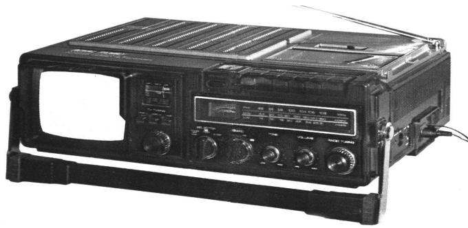
그림 3-64) 대한전선 RTC-051BW 5" B/W •세계적인 무접점 전자튜너사용 •감도 높은 실내용 로드 안테나 사용 •VHF, UHF튜너 채용으로 칼라 TV, 교육방송의 흑백수상가능 •원-터치녹음방식 및 큐, 리뷰 장치 •방송 선국, 배터리 상태, 녹음레벨상태를 언제라도 감시할 수 있는 3-Way Meter 방식채용 •자동으로 off되는 슬립기능장치 •절전설계 소모전력 극소(AC: 20W, DC: 15W), 100V/220V 겸용 카 배터리, 건전지 사용가능, 1979년 제품.
