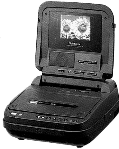
그림 4-27) 금성사 휴대용 랩탑-VTR GS-LT1 1993년 외형치수는 240x126x264mm(W.H.D), 무게는 27Kg, 소비자가격은 998,000원 이다.
