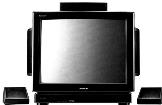
그림 3-52) 대우전자 21인치 DRQ-2173FW 1989년 모델로 평면사각브라운관 프로로직 돌비서라운드 음악출력은 14W+14W이며, 외부색상은 Black으로 외형치수579×470× 460mm(W.H.D), 소비자가격: 681,000원 이다.
