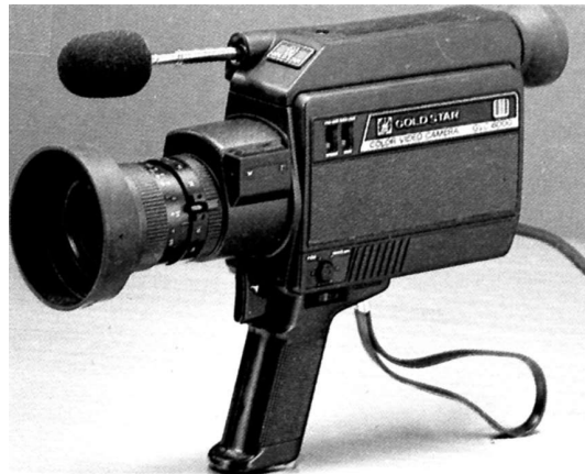
그림 5-1) 금성사가 피사체의 색채를 선명하게 재현하는 3전극 분리방식 채용한 비디오카메라 VC-6 1983년
