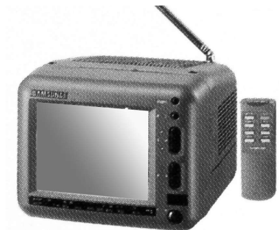
그림 3-72) 1996년 삼성전자 5" 컬러 TV CT-062R로 리모컨을 채용한 콤팩트타입으로 승용차용으로 디자인했다. 고해상도브라운관을 사용했으며, 크기는 178x138x224mm(WxHxD)이고, 소비자가격 271,000원 이다.
