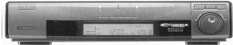
그림 4-29) 삼성전자 7헤드, 하이파이 스테레오 VTR SV-S220 1996년 외형치수는 444x92x331mm(W.H.D), 소비자가격은 999,000원이다.
