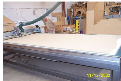
그림 86 Computer로 조정, 도면에 형태를 Route로 절단하는 모습
