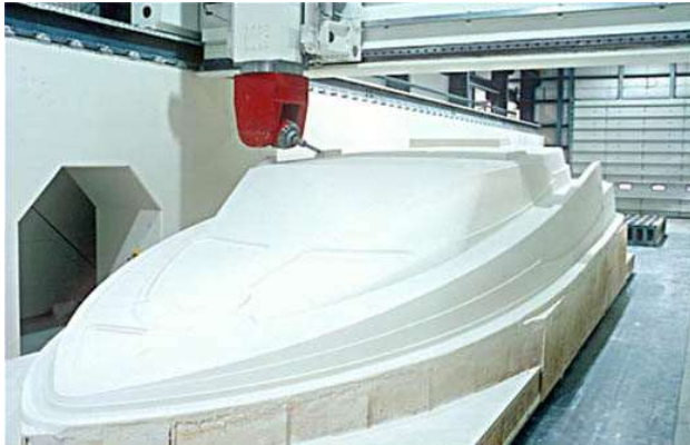
그림 88 5axis Milling Machine의 실제 작동 사진
