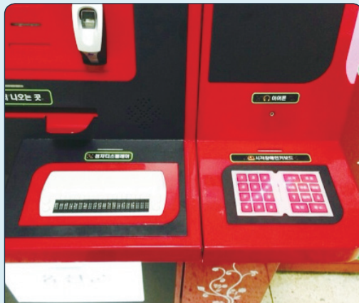
시각 장애인용 점자와 이어폰 설치
