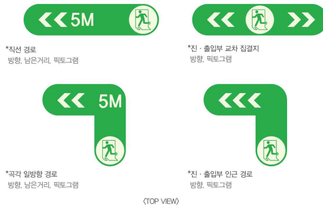
그림 4.42 피난유도 안내시설 예시(안) 레이아웃
