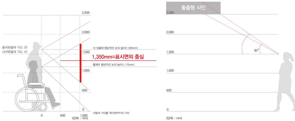
그림 3.4 벽면, 돌출형 사인 위치 선정 예시(안)
