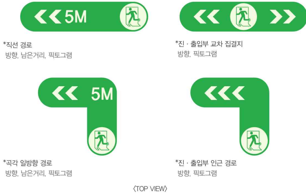
그림 4.16 비상구(피난유도선 등) 레이아웃 예시(안)
