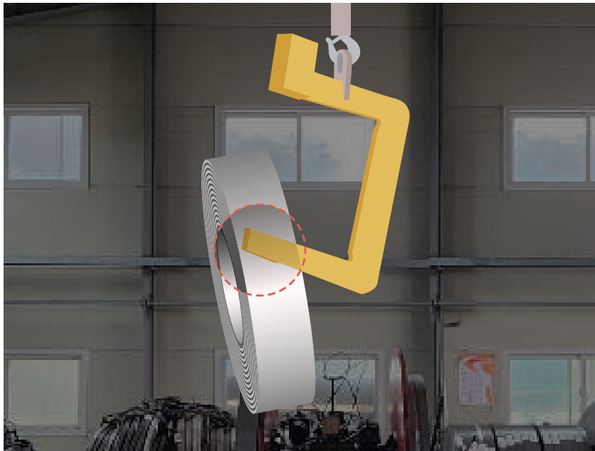
사고 당일 코일 인양 상태
