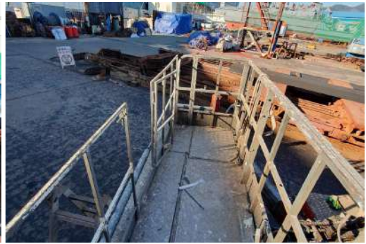
사고가 발생한 고소작업대 출입문. 자동으로 닫히지 않는 구조였다
