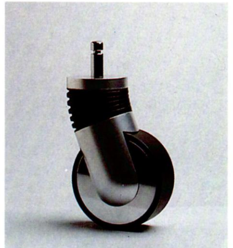
〈그림 11〉 미카엘 뢰니센(Michael Thoenissen)작 : 이 캐스터는 바퀴와 본체를 이어주는 연결축의 기능 및 조작성이 매우 중요한데, 뒷부분에서 시작된 동력이 바퀴에 전달되면 충격에 따라 축과 바퀴간에 연결된 주름진 실린더가 180°까지 꺾여지게 된다. 또한, 바퀴를 덮고 있는 양 측면의 원반은 바퀴 전체를 충격으로부터 지지하는 역할을 하고 있으며, 바퀴 케이스는 주름진 실린더의 끝과 연결되어 항상 안정된 상태를 유지하도록 하고 있다.
