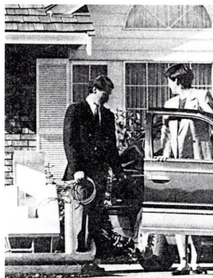
Fuelmaker는 고객의 천연가스 시스템에 직접 연결되어 4~5 시간 내에 자동차에 연료를 보급한다.
