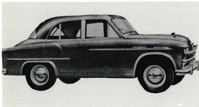
RHK형 승용차: 차체는 간또오 자동차 공업에서 만들었고 전형식(前型式) SFK의 엔진을 R형 1500cc로 바꾸었다.
