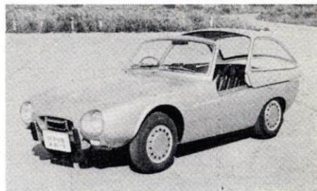
시작(試作)형의 도요다 스포츠800 : 캐빈이 후방으로 슬라이드한 형태로서 제9회 동경 모터쇼에 참고 출품되었다.
