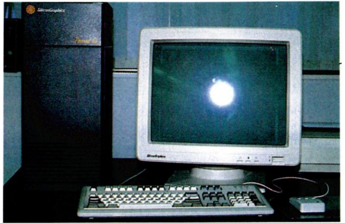
〈사진 4〉 저가의 3차원 그래픽스 워크스테이션 Personal IRIS 데스크톱은 아니지만 책상에 놓는 것 가능
