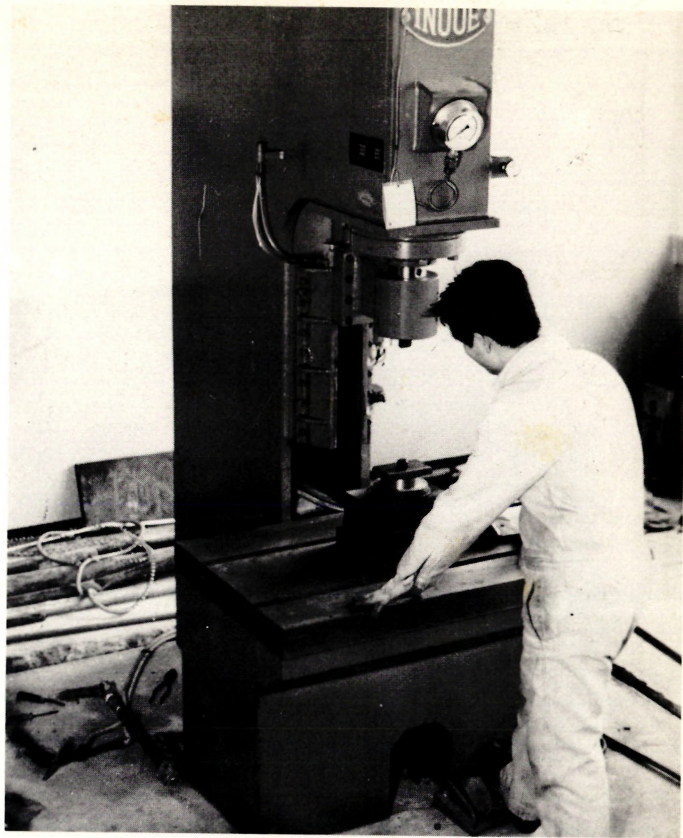
機器名: Hydraulic Press 規格型: BC-50型 機能: 各種 金属板材의 凹凸形態加工
