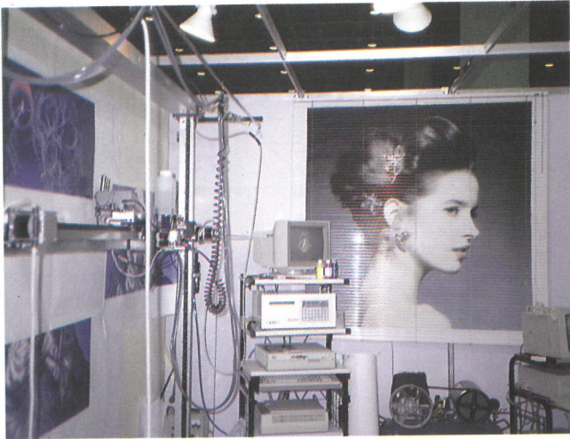
미켈란젤로(Michelangelo, V5-Paint Jet System) Paint jet System은 그리고 싶은 사진 원본을 이미지 스캐너에서 스캔하여, 플로피디스크에 입력하는 시스템. 소재의 다양성, 대형 제작, 부분별 연결작업이 가능하도록 프로그래밍화
