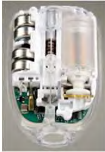
[그림 92] Omnipod 내부구조
